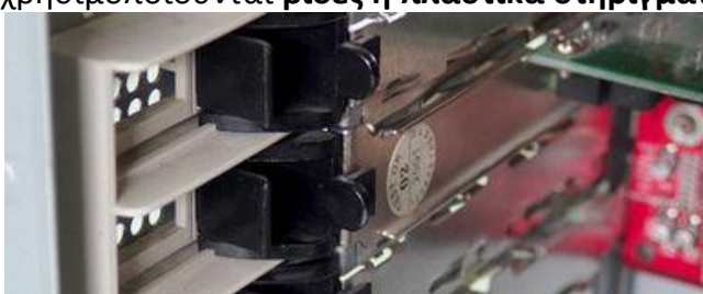
Στερέωση καρτών επέκτασης χωρίς εργαλεία
