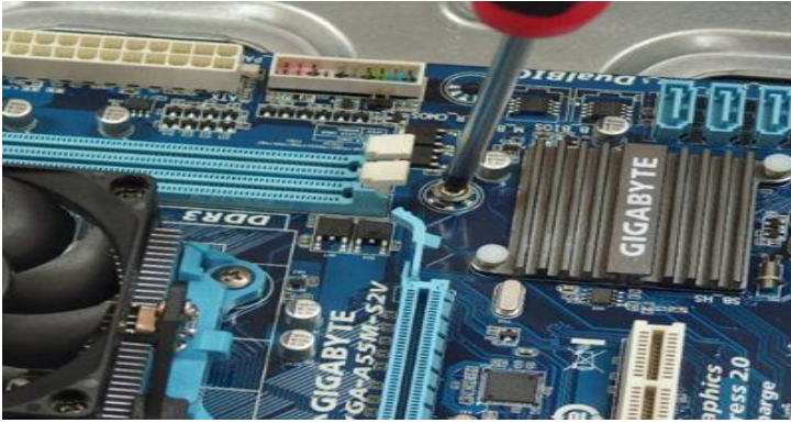
Αφαίρεση βίδας στερέωσης μητρικής πλακέτας
