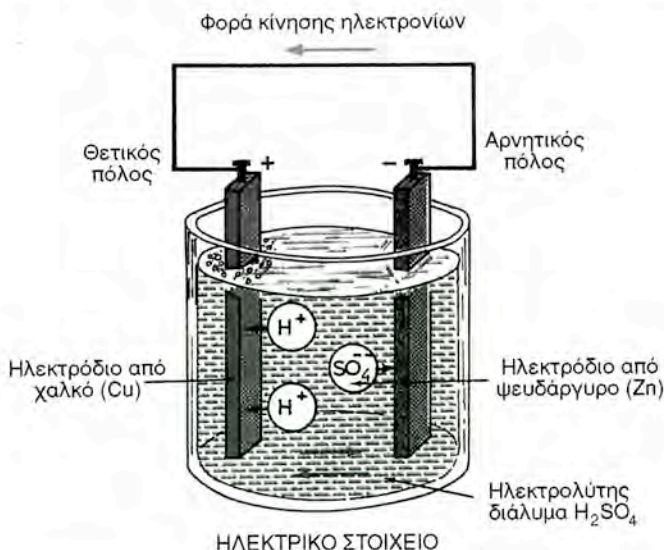
Σχήμα 1.5.α. Σχηματική παράσταση ηλεκτρικού στοιχείου για την περιγραφή της αρχής λειτουργίας του.
